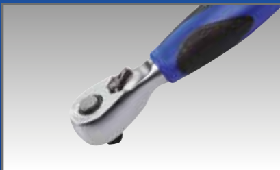
Hebelumschaltknarre, mit Auswerferstift zum Schnelllösen der Steckverbindung, 48 Zähne.
