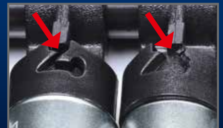
Links: Verriegelte Sicherungssperre Rechts: Entsicherte Sperre
