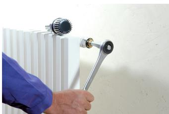
Chrom-Vanadium, verchromt, für Ein- und Ausbau von Heizkörperventilnippeln, Rücklaufverschraubungen und kurzen Hahnverlängerungen.
