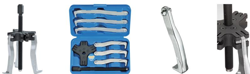
Placa base de fundición especial, brazos y husillo de acero al cromo molibdeno, sirve como extractor interior y/o exterior de 2 y 3 brazos en 8 variables. Estabilidad bajo carga como extractor de dos brazos verificado VPA - 25000 N, 1 Puente de amarre 1 Husillo 3 brazos de extracción de cada
