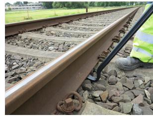
Fabricado en acero especial para herramientas, para una máxima durabilidad. El innovador perfil ovalado en doble T ofrece la máxima resistencia y un agarre firme y seguro. Estructura laminada, extremos forjados
