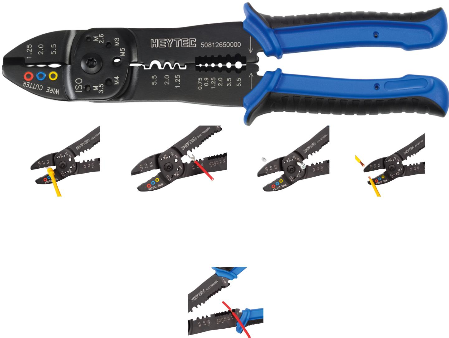
Tenaza para terminales, calidad profesional con multiplicación de fuerza. Unión con tornillo, buena estabilidad y suave accionamiento. De acero especial. Mango ergonómico con fundas de 2 componentes para un trabajo sin esfuerzo. Cortacables, para pelar cables, para comprimir terminales con aislamiento, para comprimir terminales sin aislamiento. Calidad Premium, Multifunción 5 en 1, capacidad 0.75 - 5.5 mm.
