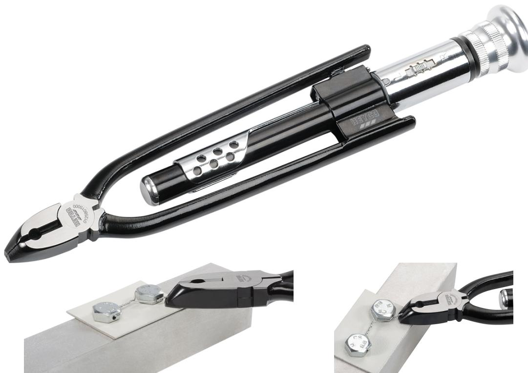
Para trenzar y cortar alambres de seguridad trenzado uniforme mediante la función de carraca. El giro a la derecha y a la izquierda posibilita el destrenzado de alambres trenzados sin daño mecánico del alambre de seguridad, retroceso automático, bocas especialmente templadas, aptas también para alambres inoxidables delgados.
