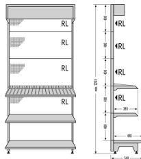
L = pintado (mediante recubrimiento con epoxy, resistente a golpes y raspados), de chapa de acero de 1,25 mm de grosor, agujeros redondos (RL), con 5 tableros de 1.000 x 400 mm, de ellos 4 con agujeros, 3 estantes lisos, un juego de separadores con listón delantero y trasero y 20 separadores, además de listón para precios para los estantes medio y superior, ambos inclinables; con pies compensadores y cabezal de iluminación.
