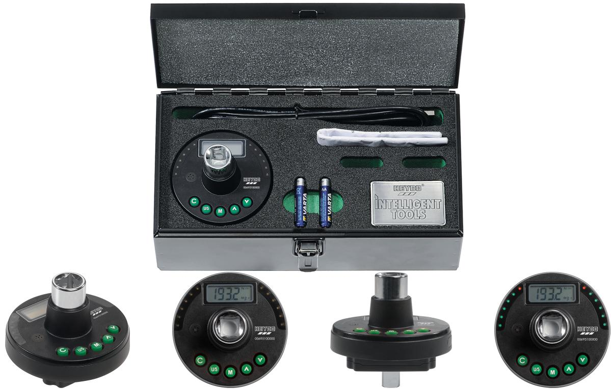
Permite la medición del par y del ángulo de torsión con cualquier tipo de carraca de 1/2", Posibilidad de preajuste de 10 valores de medición, Capacidad de memoria de hasta 50 valores de medición, Posibilidad de angulos de medición superiores a 360, Precisión de medición de ±2%, Unidades de par variables: Nm, in/lb, ft/lb, kg/cm
