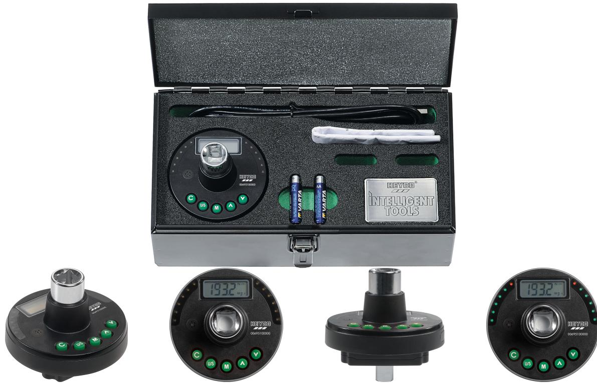
Permite la medición del par y del ángulo de torsión con cualquier tipo de carraca de 1/2", Posibilidad de preajuste de 10 valores de medición, Capacidad de memoria de hasta 50 valores de medición, Posibilidad de ángulos de medición superiores a 360, Precisión de medición de  $\pm 2\%$ , Unidades de par variables: Nm, in/lb, ft/lb, kg/cm
