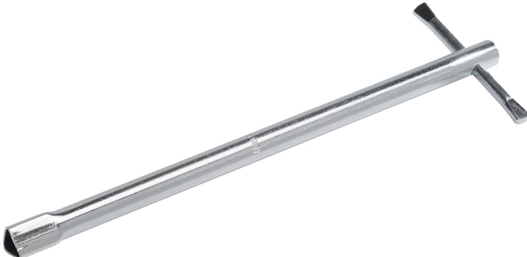
Aus nahtlos kaltgezogenem Präzisionsstahlrohr, mit durchgestecktem, beweglichem Quergriff, verzinkt, DIN 22417
