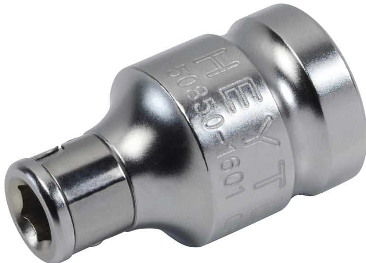
Sechskantantrieb für die Aufnahme von handelüblichen Bits. Mit diesem Adapter können 1/4" Sechskant Bits mit Akkuschrauber mit 1/2" Vierkantantrieb betätigt werden. Chrom-Vanadium-Stahl, Ausführung verchromt mit Haltekugel. Besonders geeignet für Trockenbauer, Zimmermann, Dachdecker und Gartenlandschaftsbau.
