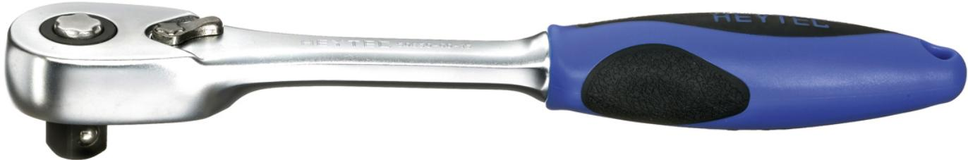
Chrom-Vanadium, verchromt. Mit Auswerferstift zum Schnelllösen der Steckverbindung, 48 Zähne. Mit ergonomischem 2-K Griff. DIN 3122 D · ISO 3315.
