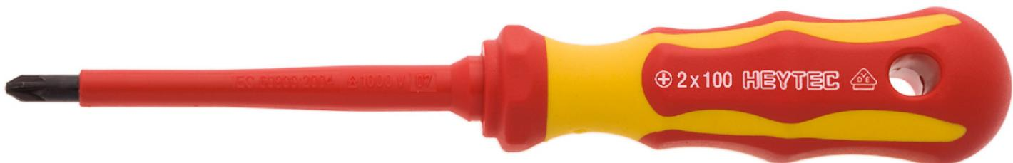
2K-VDE-Schraubendreher nach IEC 60900 : 2004/VDE 006282 Teil 201 (DIN 7437 u. DIN 7438 PZ), ergonomischer Softgriff, Klingen aus Chrom-Vanadium-Stahl, gehärtet, geschwärzt und mit umspritzter Klingenisolierung
