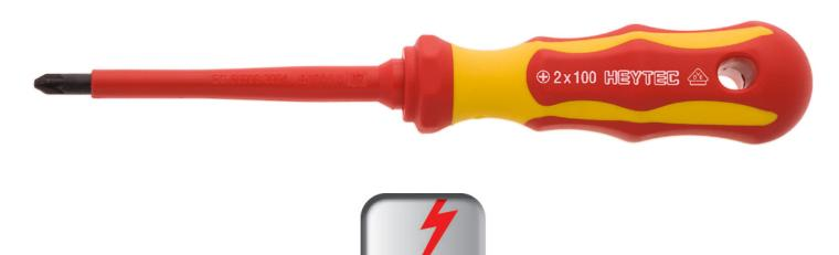
2K-VDE-Schraubendreher nach IEC 60900 : 2004/VDE 006282 Teil 201 (DIN 7437 u. DIN 7438 PZ), ergonomischer Softgriff, Klingen aus Chrom-Vanadium-Stahl, gehärtet, geschwärzt und mit umspritzter Klingenisolierung
