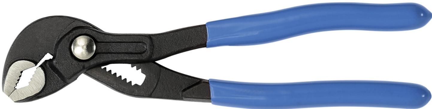
Geschmiedet und gehärtet. Öffnungsweite fest arretierbar, Entriegelung erfolgt durch Druckknopf. Tauchisolierte Griffe sorgen für einsicheres Griffgefühl. Schwarze Lackierung, Glanzpolitur der Backen. 175 mm, Öffnungsmaß max. 32 mm
