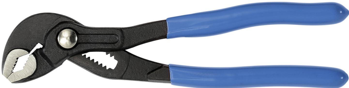
Geschmiedet und gehärtet. Öffnungsweite fest arretierbar, Entriegelung erfolgt durch Druckknopf. Tauchisolierte Griffe sorgen für einsicheres Griffgefühl. Schwarze Lackierung, Glanzpolitur der Backen. 175 mm, Öffnungsmaß max. 32 mm
