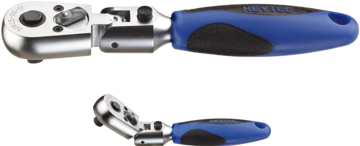
Chrom-Vanadium, verchromt. Mit Auswerferstift zum Schnelllösen der Steckverbindung, 48 Zähne. Arretierbar mit ergonomischem 2-K Griff und Gürtelclip.
