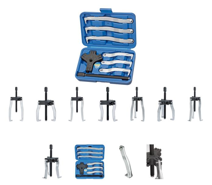
Grundplatte aus Spezialguß, Abzugsarme und Spindel aus Chrom-Molybdän-Stahl, patentierte Rasterfunktion, verwendbar als 2- und 3-armige Innen-/Außenabzieher in 8 Varianten, Belastung als 2-armiger Abzieher: 25000 N - VPA getestet. 1 Abzieherbrücke, 1 Gewindespindel, je 3 Abzieharme
