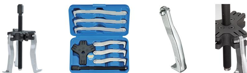
Grundplatte aus Spezialguß, Abzugsarme und Spindel aus Chrom-Molybdän-Stahl, patentierte Rasterfunktion, verwendbar als 2- und 3-armige Innen-/Außenabzieher in 8 Varianten, Belastung als 2-armiger Abzieher: 25000 N - VPA getestet. 1 Abzieherbrücke, 1 Gewindespindel, je 3 Abzieharme
