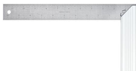
Hochwertiger Zimmermannswinkel aus Aluminium mit Lineal aus rostfreiem Stahl, Skalierung: Vorderseite in mm (300), Rückseite in Zoll (11,8), praktische Bohrung zum Aufhängen (8 mm), Anschlagschenkel mit Gehrung zum Anreißen von 45° und 90° Linien
