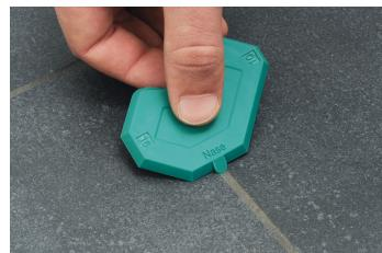
Fugenabzieher Set zum Abziehen, Glätten und Formen von dauer-elastischen Fugenmassen (17 verschiedene Möglichkeiten)
