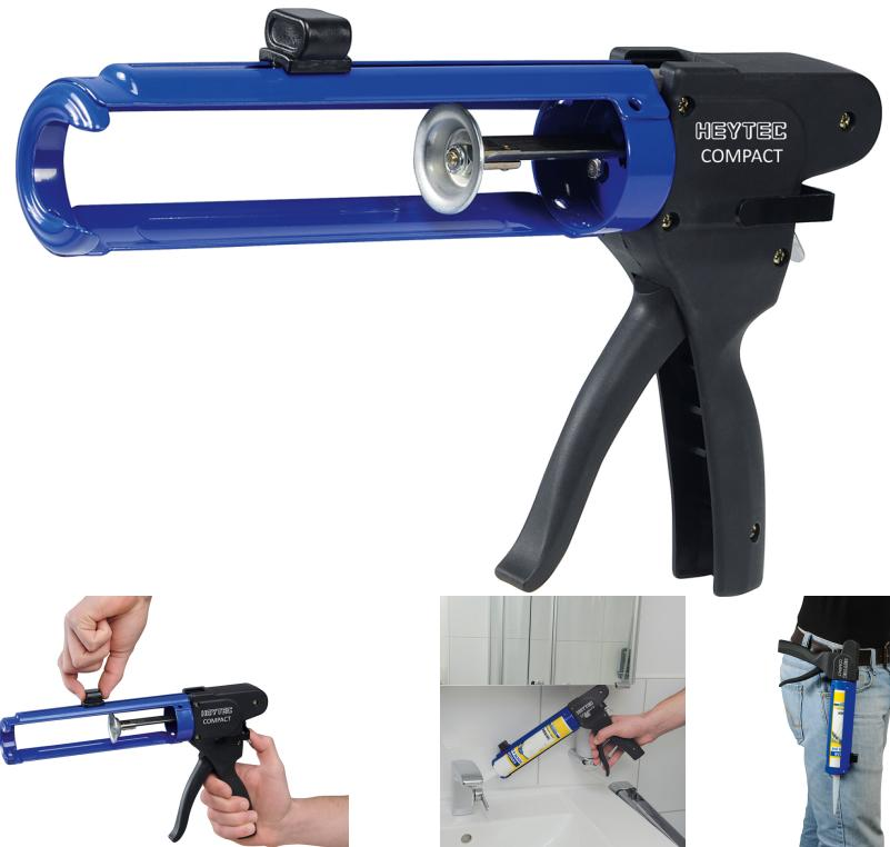
Kompakte Bauform durch innovative innenliegende Betätigungsmechanik, Gleichbleibend kompakte Abmessung, unabhängig vom verbrauchten Inhalt, mit Verbrauchsanzeige, Nachlaufstop bei Nichtbetätigung. Nur geeignet für leicht pressbare Medien, wie Silikone und Acryle. Nicht geeignet für zähe Medien, wie Kleber! Alternative: Kartuschenpistole Multipower verwenden.
