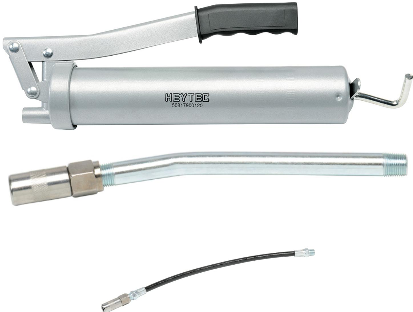
DIN 1283, L = lackiert, Kopf aus Zinkdruckguß, robuster Stahlrohrkörper mit Rändelung für rutschsichere Handhabung, zur Füllung mit Kartuschen, losem Fett und durch Füllgeräte, mit 300 mm langem Gummipanzerschlauch Ø 12 mm und 4-Backen-Hydraulikmundstück, Anschlußgewinde M 10 x 1
