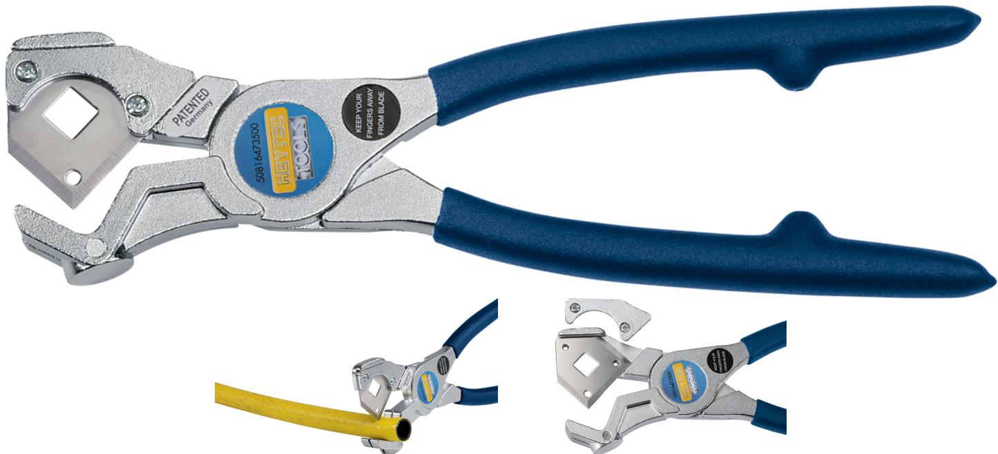
Zum einfachen Schneiden und Durchtrennen von Schläuchen aus PVC und Gummi, Schneidekapazität Ø 6-35 mm, Griff mit PVC- Isolierung für optimale Handhabung, Doppelte Standzeit/Lebensdauer, aufgrund von Doppelklingenfunktion, Halterung lösen und Klinge um 90° drehen
