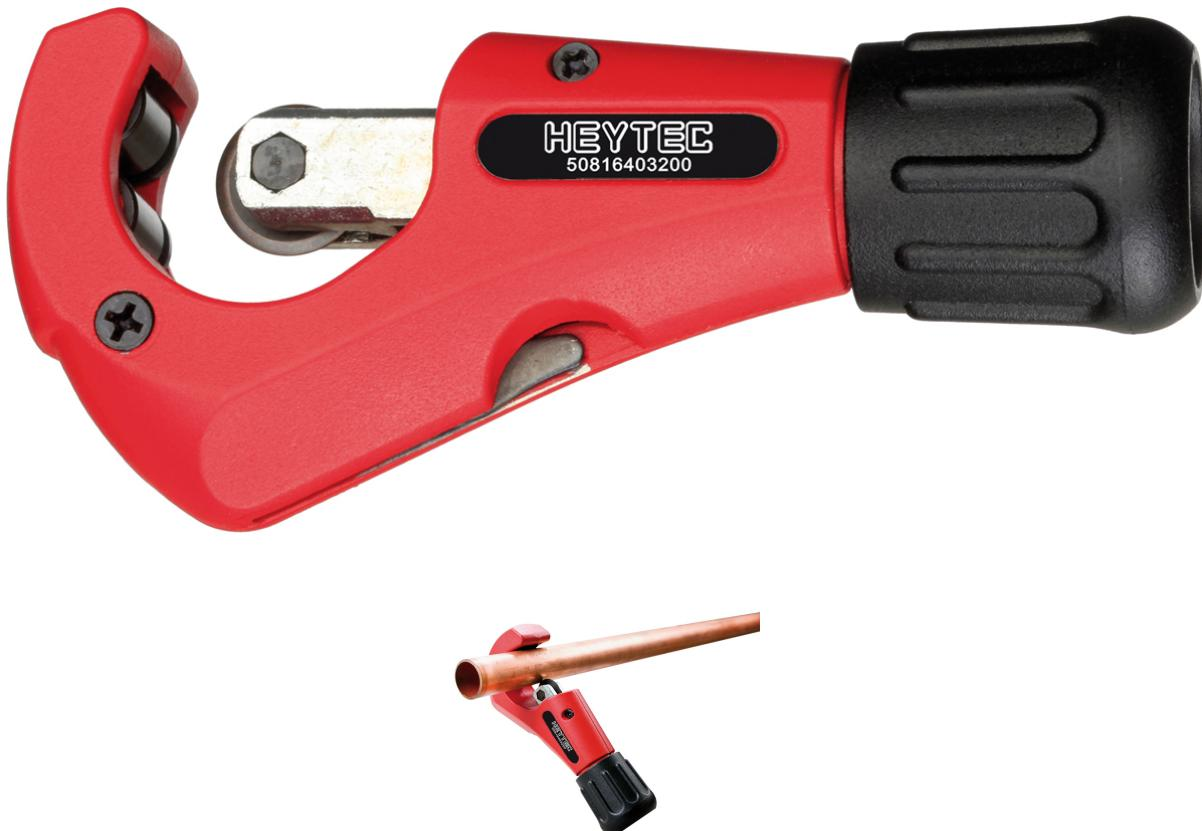
Qualitäts-Rohrabschneider für dünnwandige Rohre Ø 3-32 mm, max. Wanddicke bis 4 mm, sichere Kraftübertragung durch Teleskopführung, Schneiderad aus Spezialstahl für extrem lange Haltbarkeit, leichtes Verstellen des Arbeitsbereiches
