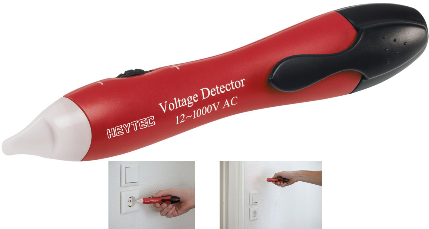
Kompaktes 2-K Kunststoffgehäuse, mit optischem und zusätzlich akustischem Signal, Einstellrad für Ein- und Ausschalten sowie zur stufenlosen Anpassung an die zu prüfende Spannung und den örtlichen Gegebenheiten. Berührungsloses Erkennen von spannungsführenden Leitern, z.B. Kabel, Steckdosen, Verteiler, Anschlussdosen etc. Lieferung erfolgt ohne Batterien.
