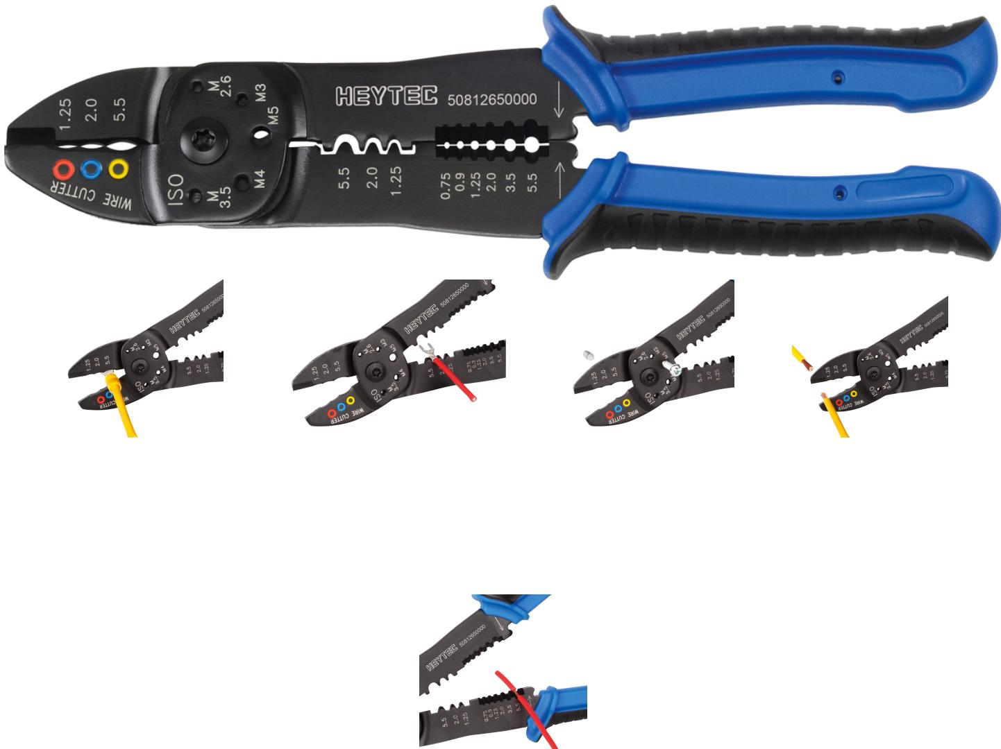
Profi Crimpzange mit Hebelübersetzung. Geschraubtes Gelenk, hohe Stabilität und gleichmäßiger Lauf. Hochfester Spezialstahl. Ergonomischer 2-K Griff für ermüdfreies Arbeiten. Zum Kabelschneiden, Abisolieren von Kabeln und Crimpen von isolierten und unisolierten Kabelschuhen und Steckverbindern. Top-Qualität, Multifunktion 5 in 1, Kapazität: 0,75 - 5,5 mm. Farbkodierte Querschnittzuordnung, Gewindelöcher zum Abschneiden von Gewindestiften.
