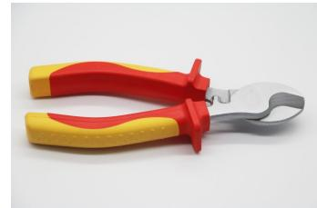
Geeignet für Cu- und Al-Mehrleiterkabel feinadrig bis Ø 15 mm (50 mm<sup>2</sup>). 2K-Griff VDE-isoliert DIN EN 60900 IEC 60900.
