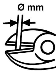
Spezialstahl, Kopf geschliffen und lackiert, Griffe mit 2-K Kunststoffhandschutz, Schneide für harten Draht (Piano Draht)
