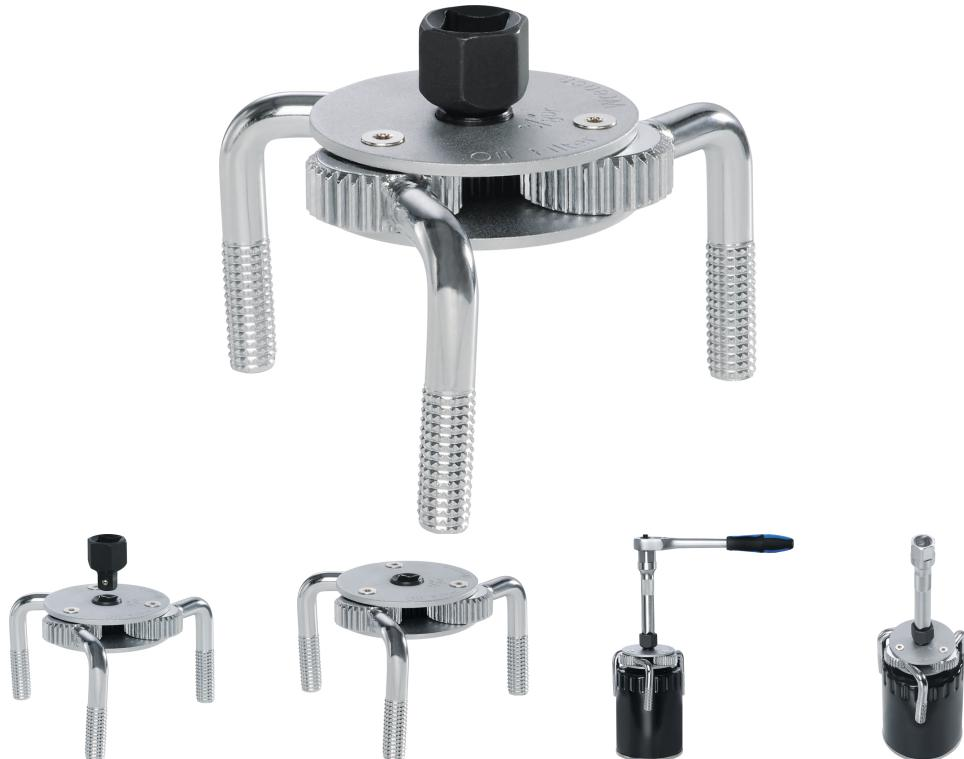
Spezialstahl, geschmiedete Ausführung, Oberfläche verzinkt, universell zu verwenden, für 1/2" und 3/8" Antriebe, SW 22, Ø 65-120 mm, rechts + links Lauf
