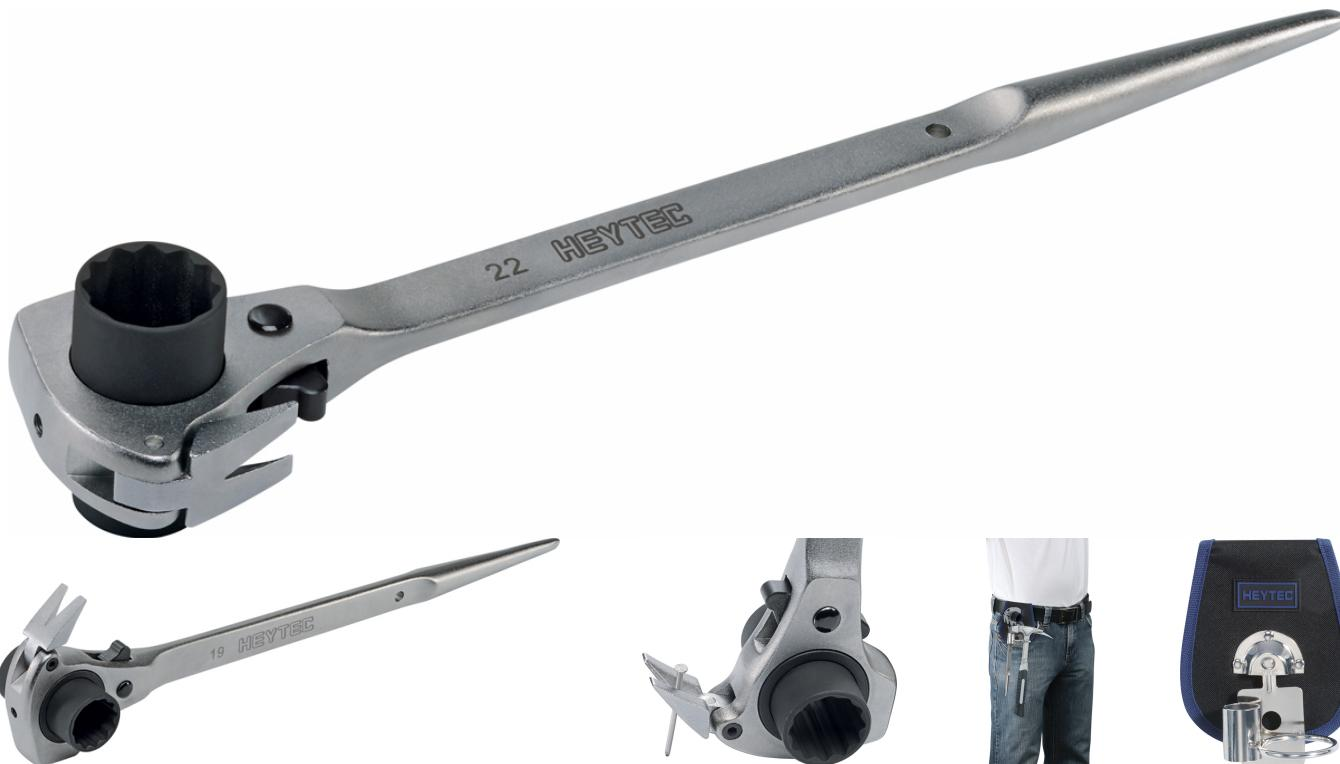
Chrom-Vanadium, verchromt. Diese Gerüstbauknarre ist ein extrem stabiles Modell, mit Umschaltknarre und einem Durchlass für den Gewindestab. Mit integriertem ausklappbarem Nagelzieher. Das Ende des Handgriffs ist als Dorn ausgeführt und ermöglicht somit ein schnelles Justieren der Bauteile.
