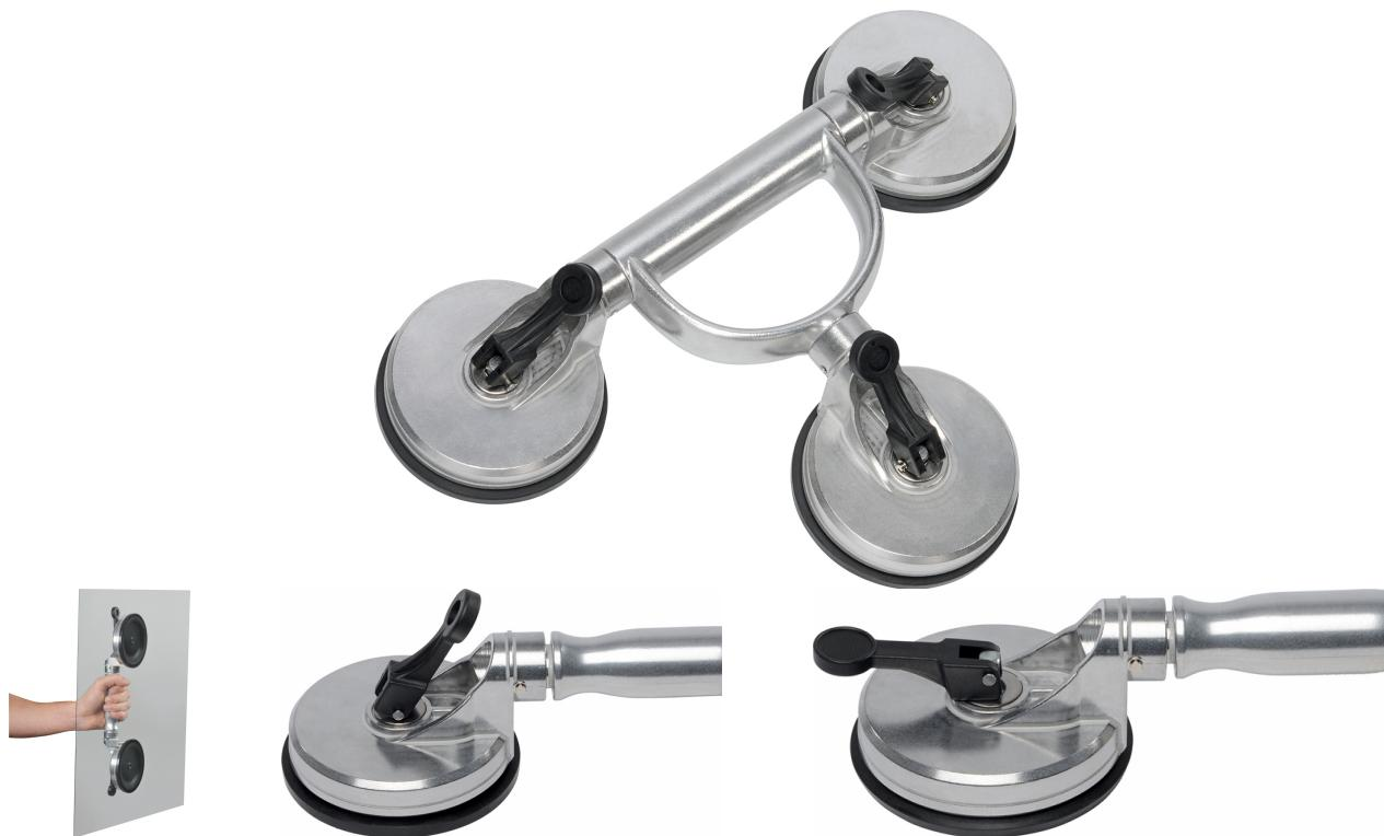
Aus hochwertigem Aludruckguss. 3 bewegliche Saugköpfe (120 mm), Ansaugmechanik und Sicherheitsverriegelung. Ideal zum Transportieren, Ein- und Ausheben von PKW-Glas, Duschwannen, Fensterscheiben, Türen, Blechen, etc.. Traglast gesamt: 120 kg
