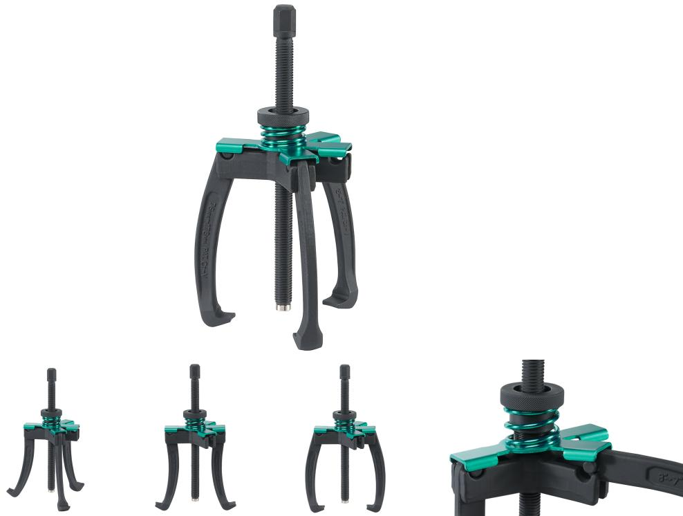
Stufenlos einstellbarer Schwenkbereich durch Federdruck, Verwendung als 2- und 3- armige Außen- und Innen- Abzieher durch einfaches Umstecken der Haken
