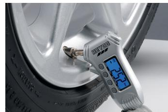
Profiltiefe-Messung: 0-22 mm / 8", Reifendruck-Messung: 0-7.0 Bar / 0-100 PSI / 0-7.0 kg/cm<sup>2</sup>, Licht, Genauigkeit: ± 1%, inkl. Batterie 3 V CR2032
