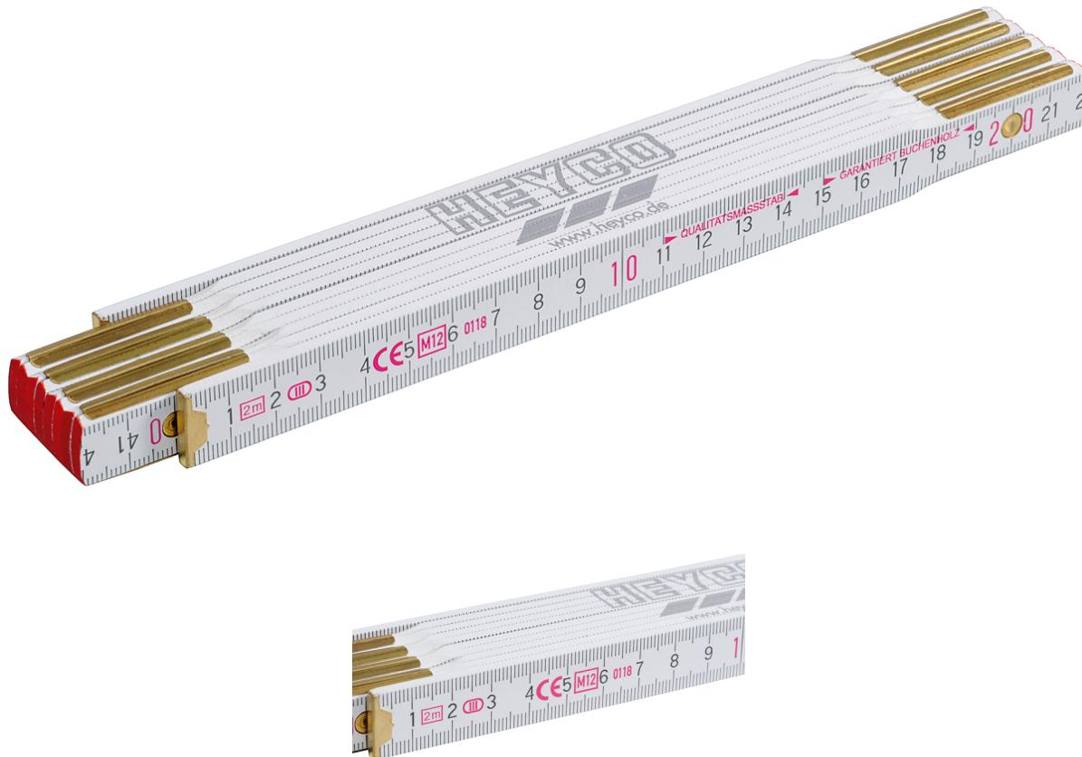
Genauigkeitsklasse EG III, aus Buchenholz, Gliederstärke 3,0 mm, Gliederhöhe 16 mm, Gliederzahl 10, durchgenietete Gelenke und vermessigte Stahlfedern, 2 m Länge
