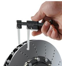
Zum Messen der Bremsscheibenstärke bei PKW + Motorrädern im eingebauten Zustand, aus rostfreiem Stahl, mit Feststellschraube und zusätzlicher Reifenprofil-Messlehre, Meßbereich: 0-60 mm
