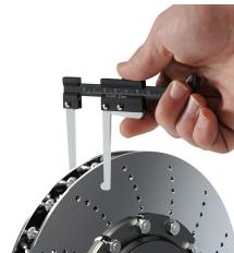
Zum Messen der Bremsscheibenstärke bei PKW + Motorrädern im eingebauten Zustand, aus rostfreiem Stahl, mit Feststellschraube und zusätzlicher Reifenprofil-Messlehre, Meßbereich: 0-60 mm
