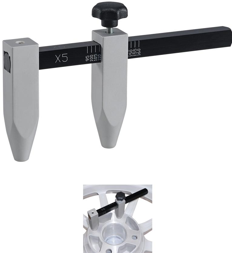
Für Lochkreis-Messungen an Stahl- und Alufelgen, einfaches Ermitteln des Lochkreises, geeignet für 3-, 4-, 5- und 6-Loch Felgen, Messwerte-Ermittlung in mm, Feststellschraube zum Fixieren des Messwertes, hochwertige Aluminium-Ausführung
