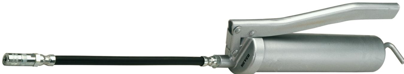
DIN 1283, L = lackiert, Kopf aus Zinkdruckguß, robuster Stahlrohrkörper mit Rändelung für rutschsichere Handhabung, zur Füllung mit Kartuschen, losem Fett und durch Füllgeräte, mit 300 mm langem Gummipanzerschlauch Ø 12 mm und 4-Backen-Hydraulikmundstück, Anschlußgewinde M 10 x 1
