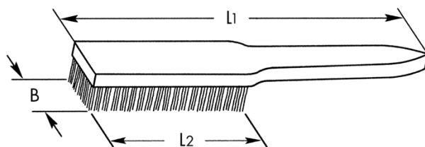
ST = standardmäßig, glatter Stahldraht Ø 0,35 mm
