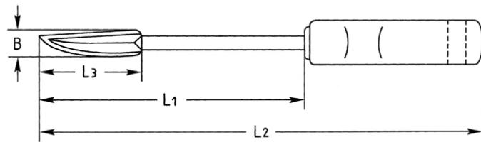
Z = verzinkt, speziell geeignet für problemlose und rückstandsfreie Beseitigung von Dichtungsresten
