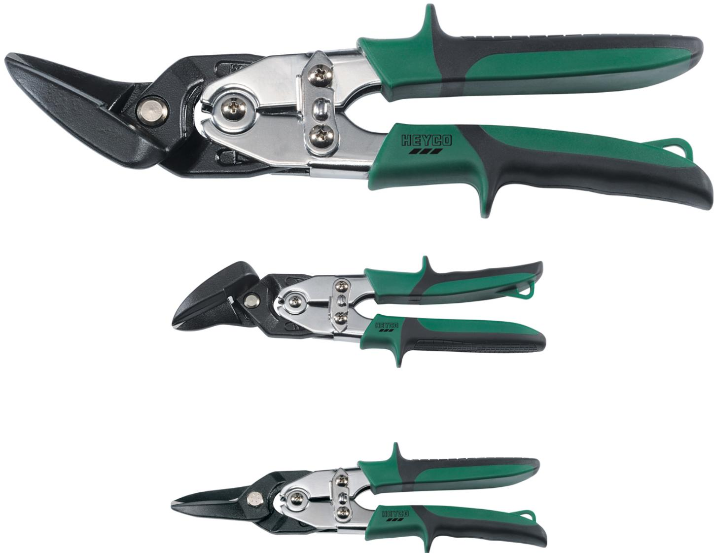
Figuren- und Durchlaufscheren, BI = brüniert, Kunststoffhüllen mit Gleitschutz, selbstöffnend durch eingebaute Feder, Chrom-Molybdän-Stahl, phosphatiert, HRC 60-62, Schneidekapazität: Metall bis zu 1,5 mm, Edelstahl bis zu 0,9 mm 1621-1 rechtsschneidend 1621-2 linksschneidend 1621-3 gerade
