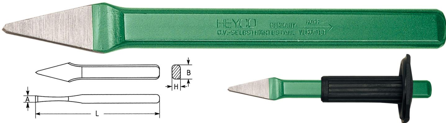
DIN 6451, Chrom-Vanadium, LS = lackiert, Blatt und Schneide geschliffen, flach-ovale Form, Lufthärtestahl, Sicherheits-Schlagkopf
