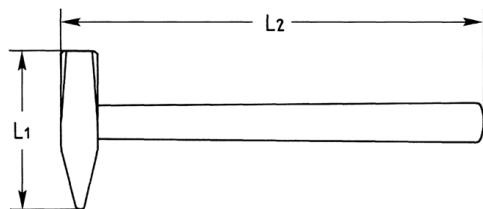
ST = standardmäßig, Gehäuse mit Stahlschrot gefüllt – durch Gewichtsverlagerung beim Auftreffen, optimale, rückprallfreie Schlagwirkung, auswechselbare Nylonköpfe, Hickory-Stiel
