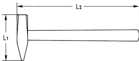
ST = standardmäßig, Gehäuse mit Stahlschrot gefüllt – durch Gewichtsverlagerung beim Auftreffen, optimale, rückprallfreie Schlagwirkung, auswechselbare Nylonköpfe, Hickory-Stiel
