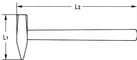
LS = lackiert, Bahn und Pinne geschliffen, deutsche Form, doppeltgeschweifter Eschenstiel nach DIN 5111, Kunststoffversiegelt, DIN 1041
