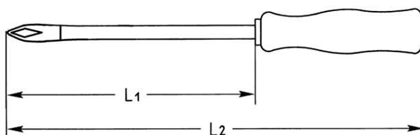
DIN 7438, Chrom-Vanadium, BV = brüniert, schutzisoliert gemäß DIN EN 60900, mit eingespritzt ummantelter Klinge, mit schlagfestem Kunststoffheft
