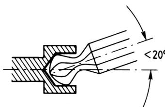
Chrom-Vanadium, B = brüniert, in Kunststoffhaltern, zum Schrauben von schwer zugänglich liegenden Innen-TORX®-Schrauben in einem Arbeitswinkel von bis zu 20°
