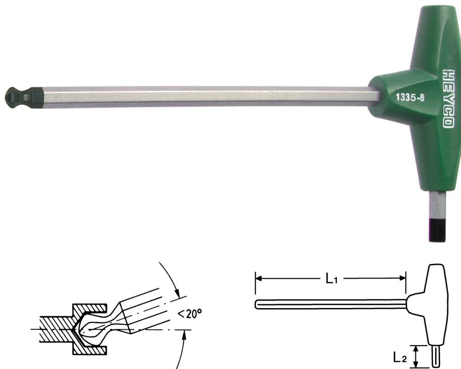
Chrom-Vanadium, C = verchromt (mit schwarzer Spitze) mit schlagfestem Kunststoffheft, zum Schrauben von schwer zugänglich liegenden Innensechskantschrauben in einem Arbeitswinkel von bis zu 20°
