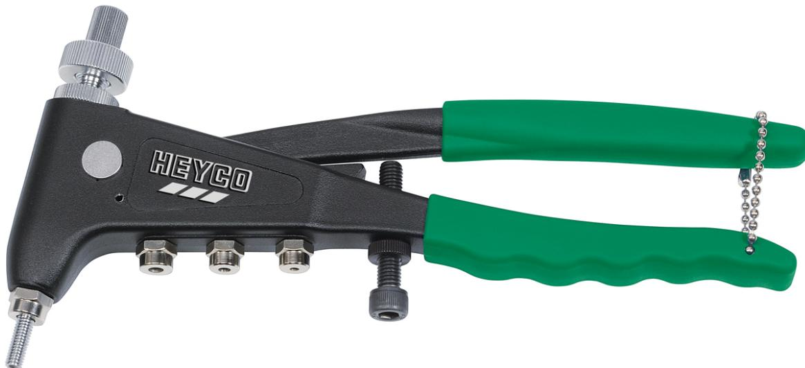
ST = standardmäßig, Gehäuse aus Aludruckguß, mit stahlgeschmiedeten Betätigungshebel, 4 auswechselbare Mundstücke (M3, M4, M5, M6), selbstöffnend durch integrierte Feder, stufenlos verstellbarer Anschlag, ergonomischer Softgriff
