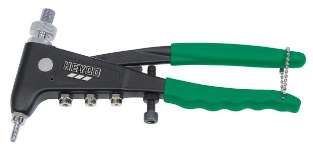
ST = standardmäßig, Gehäuse aus Aludruckguß, mit stahlgeschmiedeten Betätigungshebel, 4 auswechselbare Mundstücke (M3, M4, M5, M6), selbstöffnend durch integrierte Feder, stufenlos verstellbarer Anschlag, ergonomischer Softgriff
