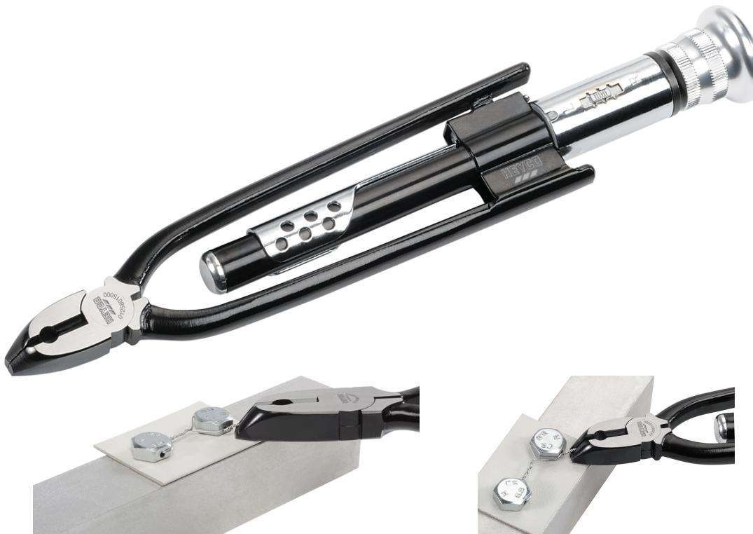
zum Verwirbeln und Schneiden von Sicherungsdrähten, gleichmäßige Verwirbelung durch Ratschenfunktion, Rechts- und Linksdrehung ermöglicht die Öffnung von verwirbelten Drähten ohne mechanische Beschädigung des Sicherungsdrahtes, automatische Rückführung, spezial gehärtete Backen, auch für dünne Edelstahldrähte geeignet
