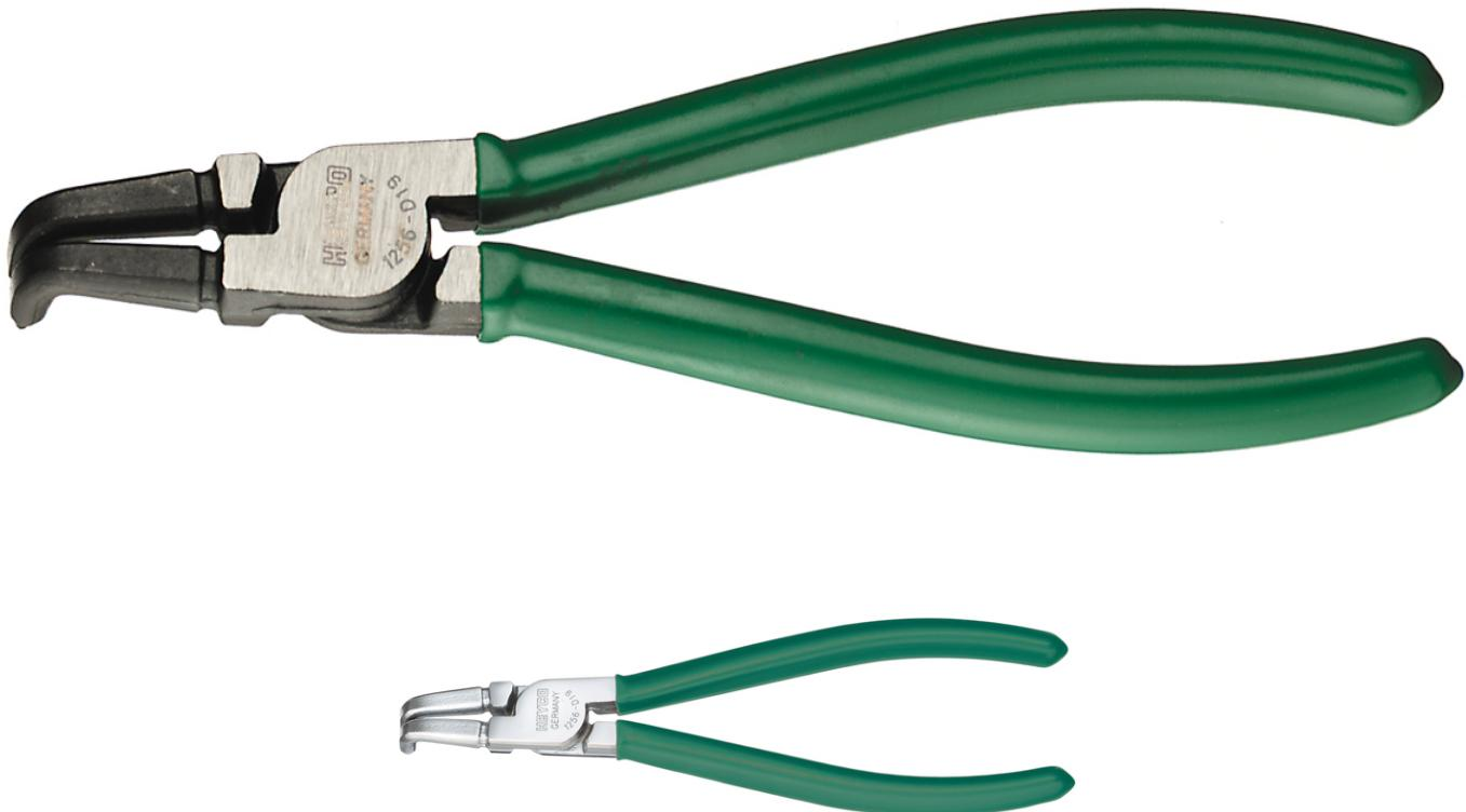
DIN 5256 D, Chrom-Vanadium, ASD = schwarz, Gelenk geschliffen, Griffe kunststoffbeschichtet, CPD = verchromt, Gelenk poliert, Griffe kunststoffbeschichtet, mit gewinkelten Backen, Spitzen schwarz, für Innen-Sicherungsringe (Bohrungen) nach DIN 472 + 984
