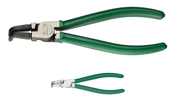
DIN 5256 D, Chrom-Vanadium, ASD = schwarz, Gelenk geschliffen, Griffe kunststoffbeschichtet, CPD = verchromt, Gelenk poliert, Griffe kunststoffbeschichtet, mit gewinkelten Backen, Spitzen schwarz, für Innen-Sicherungsringe (Bohrungen) nach DIN 472 + 984
