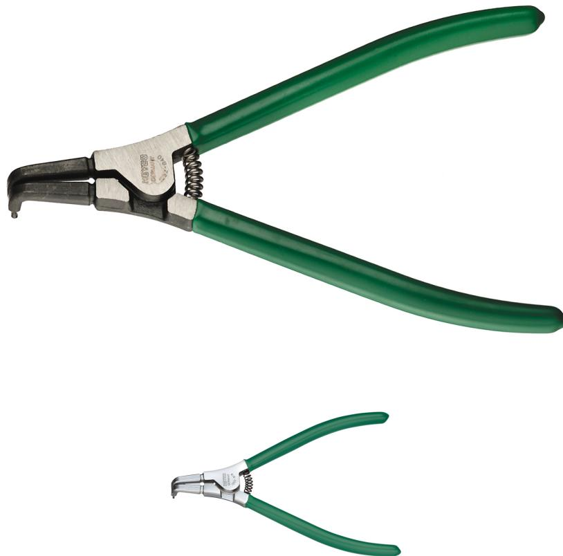
DIN 5254 B, Chrom-Vanadium, ASD = schwarz, Gelenk geschliffen, Griffe kunststoffbeschichtet, CPD = verchromt, Gelenk poliert, Griffe kunststoffbeschichtet, mit gewinkelten Backen, Spitzen schwarz, für Außen-Sicherungsringe (Wellen) nach DIN 471 + 983
